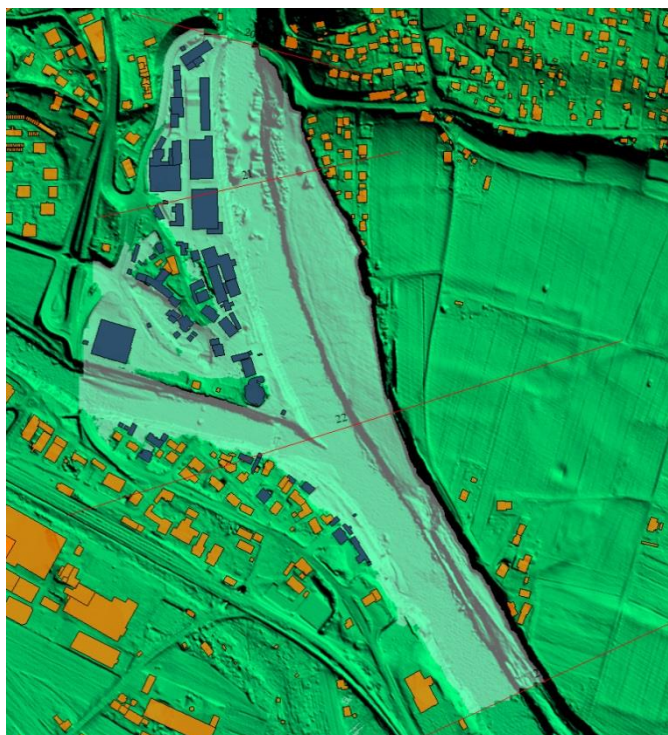
Slika 4: Približni prikaz območja maksimalnega poplavnega vala (2D aproksimacija razlitja), kot je izračunan v enodimenzijski 1D študiji (R. Rajar 1973). Objekti, ki bi jih dosegel poplavni val, so označeni modro.
